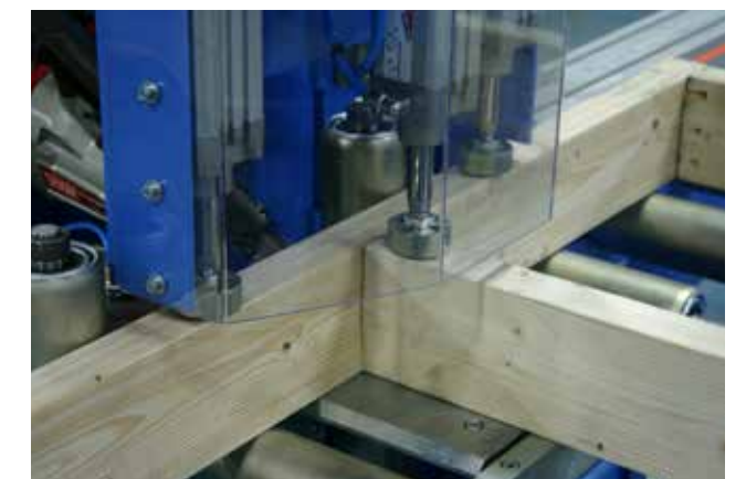
Detailansicht des Spannsystems der Rahmenstation FM1000TS. Diese ermöglicht Holzrahmenbau in hoher Qualität bei großer Kapazität.
