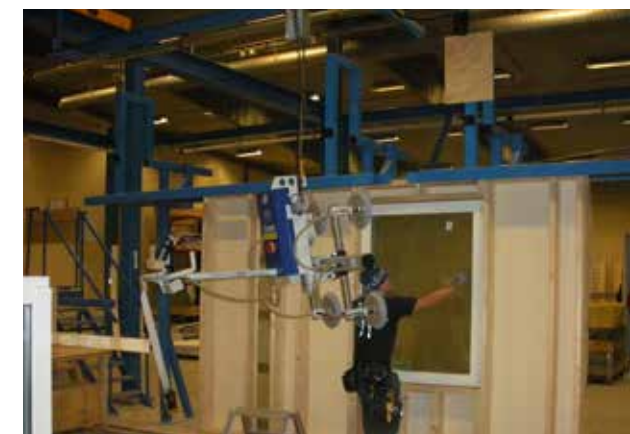
Effektiver Fenstereinbau in einem Ausfördersystem für Elemente in vertikaler Position.
