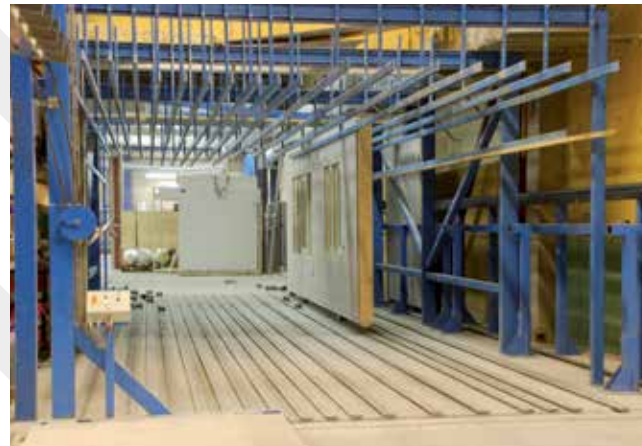
Wegklappbare Bolzen ermöglichen das Weiterführen der aufgerichteten Wand vom Einfach-System direkt in ein Lagersystem.
